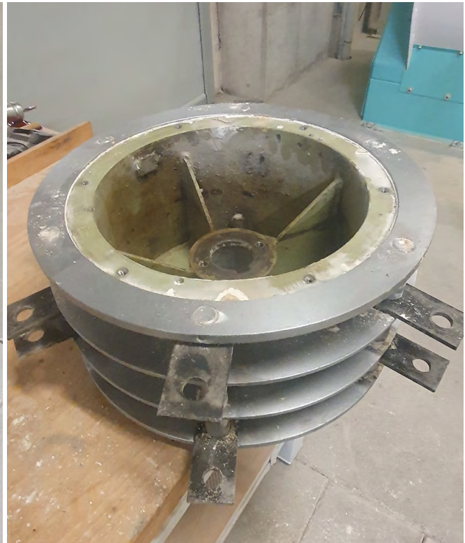
Die Hämmer bei diesem Rotor wurden auf ein Drittel der ursprünglichen Anzahl reduziert. Sie sind gegenüberliegend, immer in der gleichen Position angebracht. Das Sieb hat einen Lochdurchmesser von 3.5 mm.
